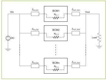
*Figure 17 – BCM*<sup>™</sup> *module array*
